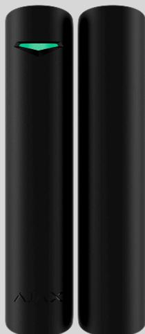
**Superior DoorProtect G3 Jeweller** ist ein kabelloser Öffnungsmelder mit Reedschalter, Erschütterungs- und Neigungssensoren sowie Fremdfeldüberwachung. Er unterstützt den Anschluss eines kabelgebundenen Melders eines Drittanbieters mit einem normal geschlossen Kontakt (NC). Das Gerät ist nur für den Einsatz im Innenbereich geeignet.
